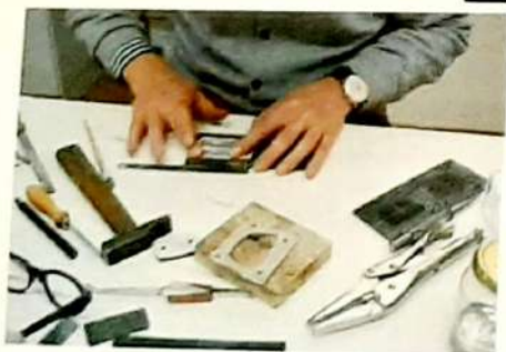
Ludovic colle le dessin, ayant la forme choisie par le client, sur le gabarit. Cela lui permettra de découper les contours de la forme.
