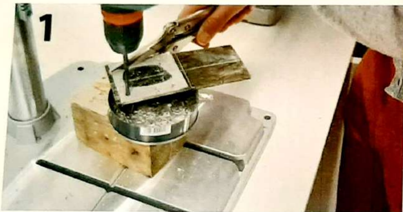
La préfabrication de la lunette débute avec la fusion de la forme d'un verre et d'une plaque en métal. Le métal est ensuite récupéré, car très coûteux.
