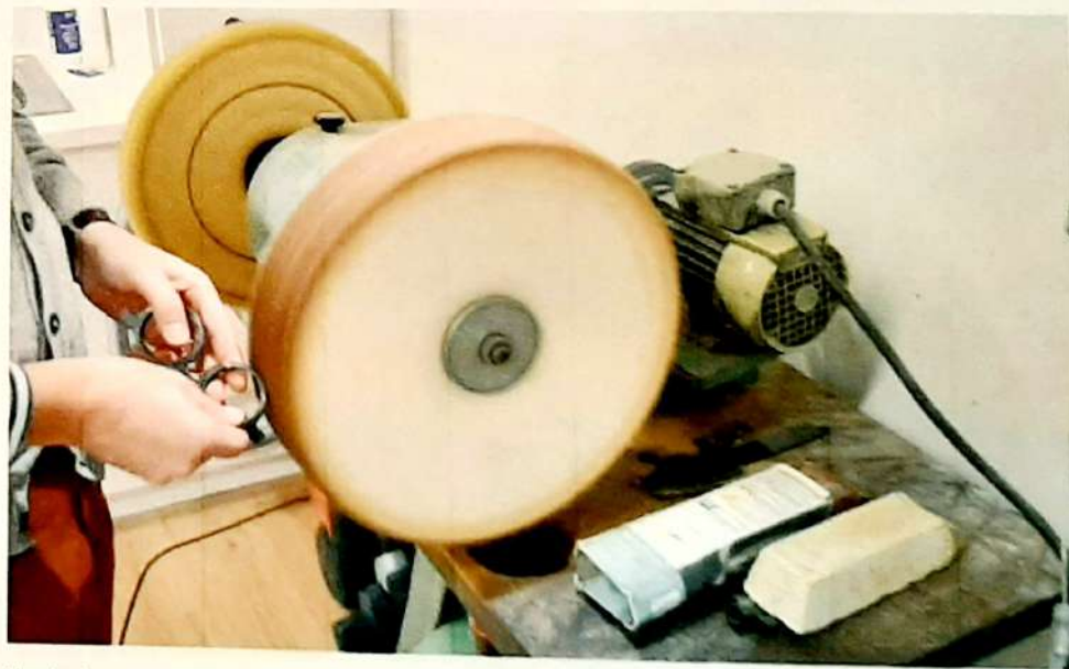
Une des dernières étapes est l'utilisation de la peau de chamois. Celle-ci va permettre d'aligner au mieux les contours de la lunette qui est alors presque prête d'être portée par le client.
